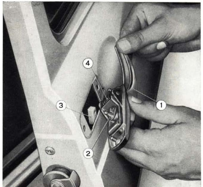
**Fig. 394 - Removing door handle.**
