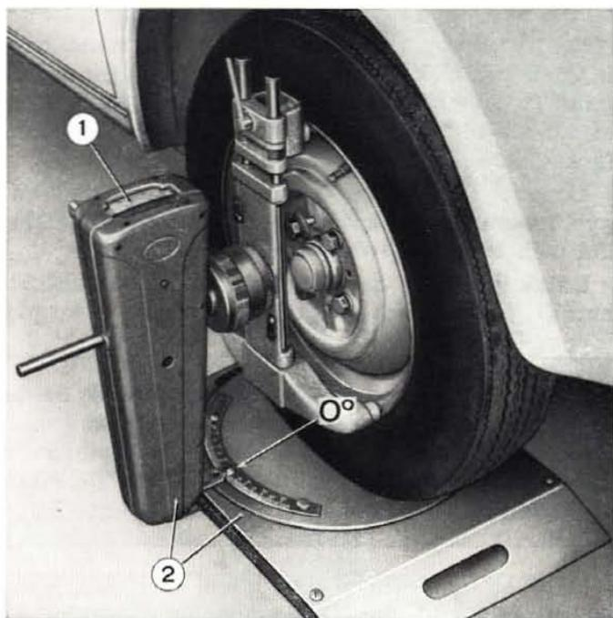
**Fig. 234 - Checking camber.**
