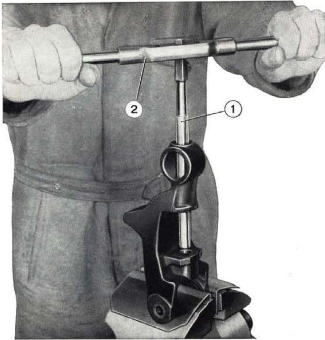
**Fig. 221 - Reaming kingpin bushings.**
