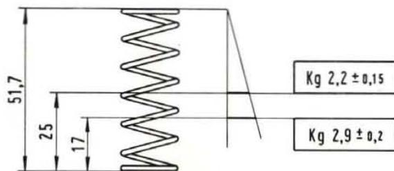
Fig. 109 - Rocker spring checking data.
