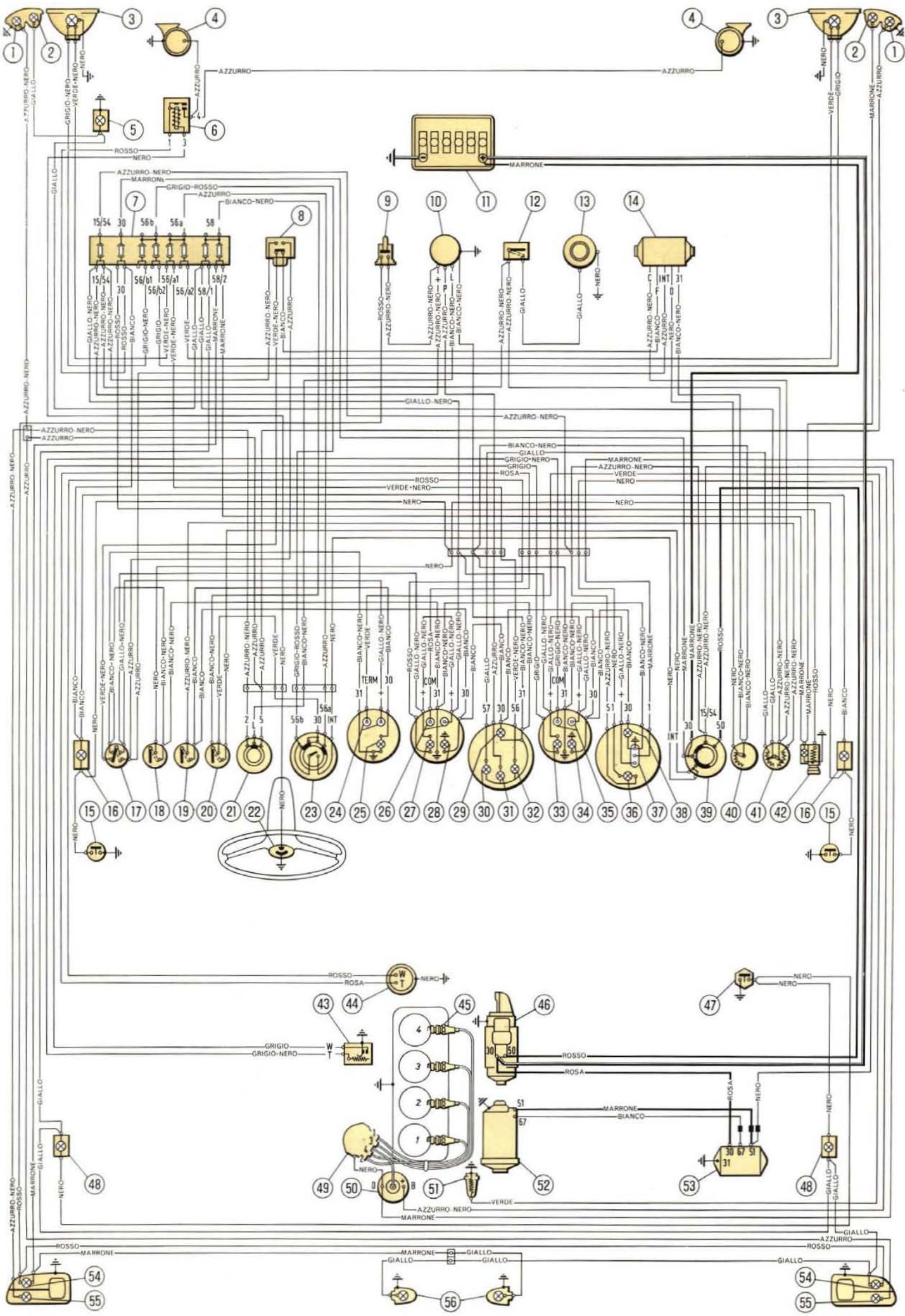
Fig. 501 - Wiring diagram.
