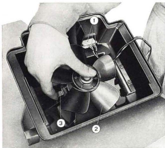
**Fig. 309 - Fitting electrofan.**
